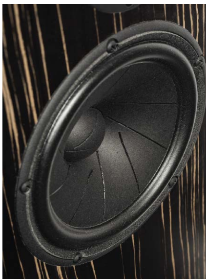
Najnowszy w tym zestawie jest wyspecjalizowany przetwornik średniotonowy – 18-cm Revelator, ze znaną już nacinaną membraną, ale z innym niż w nisko-średniotonowych piankowym zawieszeniem i inną cewką.
