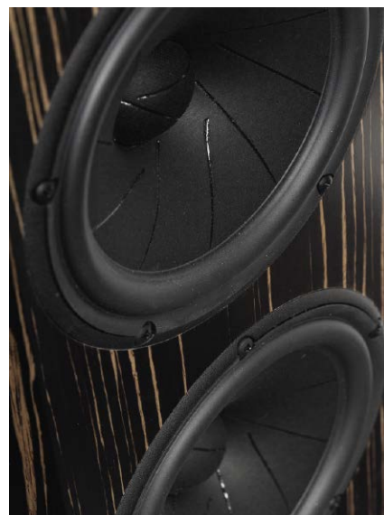
Dwa niskotonowe, 18-cm Revelatory (w tej roli znane od dawna nisko-średniotonowe) w bas-refleksie „zejdą” bardzo nisko, ale potrzebują do tego sporej objętości.
